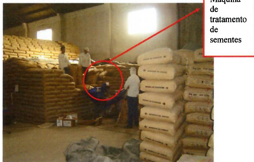
Figura 4.1 – Falta de aberturas, obstáculos e ventilação deficiente
