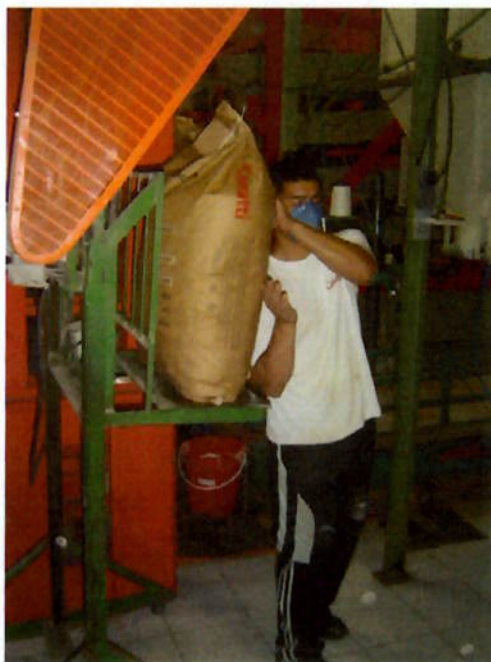
Figura 4.8 – Aparelho que facilita o carregamento de sacos de semente
