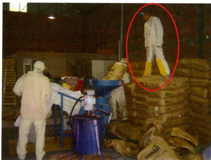
Figura 4.6 – Trabalhador com EPI retirado e risco de queda Fonte: Arquivo pessoal
